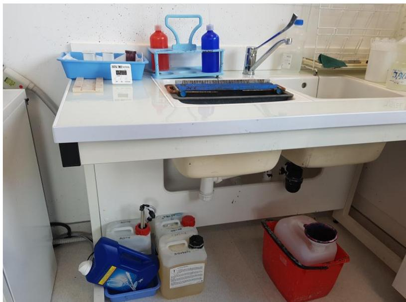
Opérations manuelles de vidange du formaldéhyde, des solvants ou réactifs, sur un poste de travail dépourvu de dispositif d'aspiration à la source
